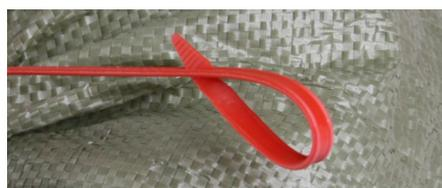
С помощью Г-образного упора сделайте надежную петлю и окончательно затяните гибкий элемент.
